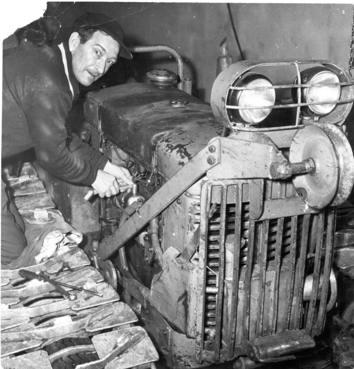
Uno Öhlund 'Klabbarparn', 1912–2010, med sin traktor. En Fiat helbandad, ombyggd för att lyfta snöplogen vid plogning av timmervägar. År ca 1965.
